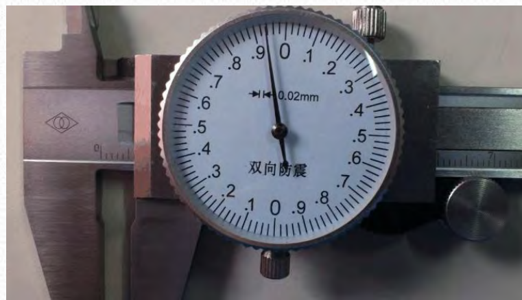
上图：主尺上的值为“5mm”，为奇数，那么我们在表盘上面的的读数则取左半圈数值，为“0.92mm”，总数值为“5.92mm”。
