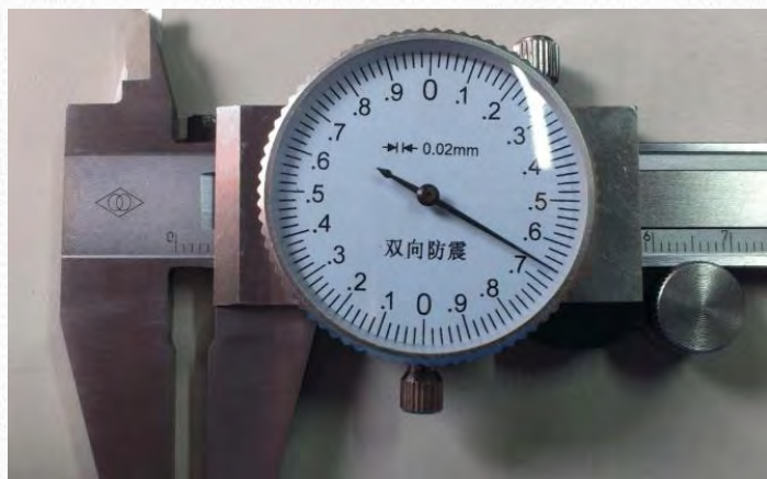
上图：主尺上的值为“4mm”，为偶数，我们在表盘上面的读数则取右半圈数值，为“0.66mm”，总数值为“4.66mm”。
